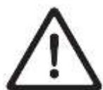
**Upozorenje!** Da se uređaj ostavi bez napona potrebno ga je isključiti sa električne mreže. Nije moguće uređaj ostaviti bez napona tako što ćemo ga isključiti na prekidač ili podešavanjem neke opcije na upravljačkom panelu!
