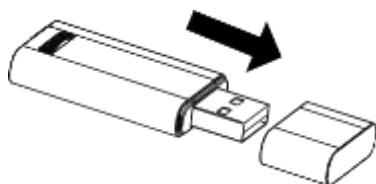
2) Otvorite prednju ploču, a zatim umetnите WIFI adapter u konektor unutrašnje jedinice.
